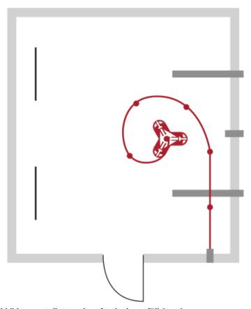
Abbildung 3: Pellet Maulwurf E3 in der Befüllsituation
