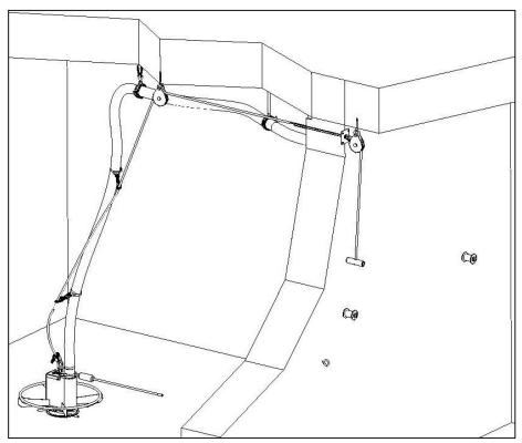
Abbildung 1: Sonnen-Pellet Maulwurf Classic mit Handhebezug im leeren Lagerraum
