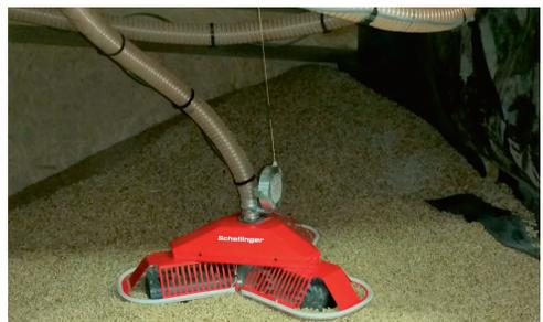
**Ziel:** Maulwurf E3 sitzt auf den Pellets. Schlauch verläuft in leichtem Bogen zur Decke.
