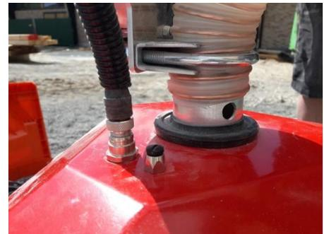
Bei einer Gesamtschlauchlänge über 10 m vom Maulwurf Gerät bis zum Heizkessel empfehlen wir die Nebenluftöffnung am Mauwurf Saugstutzen zu öffnen. Hierzu wird der Schlauch am Saugstutzen soweit nach oben geschoben, bis die Bohrung (10 mm) am Saugrohr frei liegt.
