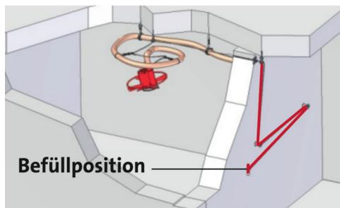
Maulwurf mittels Seilzug über die zwei Umlenkrollen an die Decke ziehen, Seilverlauf siehe Grafik.
