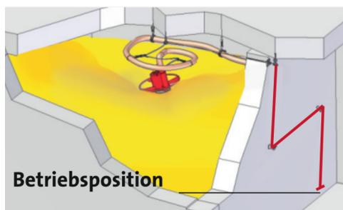
Pelletlager öffnen, Böschung unterhalb des Maulwurfs eibenen. Handgriff aushängen, Maulwurf langsam auf die Pellets absenken.
